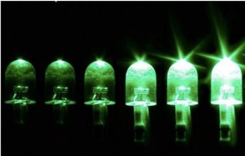
Le principe du chenillard est de décaler, de proche en proche, l'allumage des LED, afin de créer un mouvement apparent de lumière.
