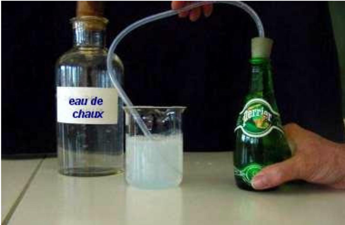
**Lorsque de l'eau de chaux est en contact avec du dioxyde de carbone, elle se trouble.**
