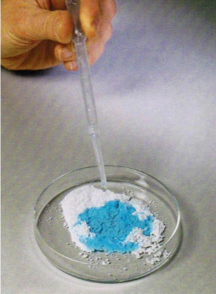
Lorsque le sulfate de cuivre anhydre est en contact avec de l'eau il devient bleu.
